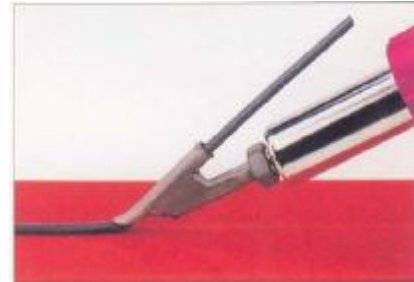
Soldando cordón de PVC
