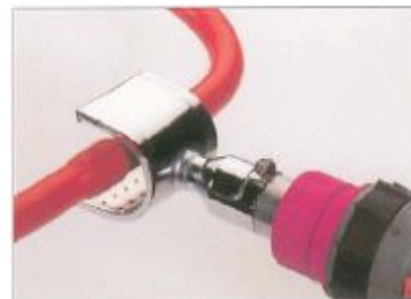
Curvado de tuberías
