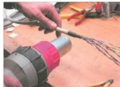
Calentado y retractilado de terminales
